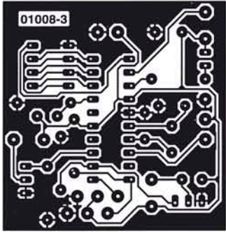
Figura 4. Placa de circuito impreso del circuito de marcha rápida/lenta.
